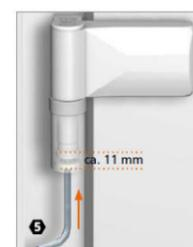
Höhenverstellung (Vertikalverstellung) stufenlos aus der Nullstellung. Anheben + 4 mm / Absenken - 3 mm Die Höhenverstellung nur mit intaktem 5er Inbusschlüssel (kein Kugelkopf!). Mit dem Schlüssel vor der Verstellung bis zum Anschlag eintauchen (ca. 11 mm).
